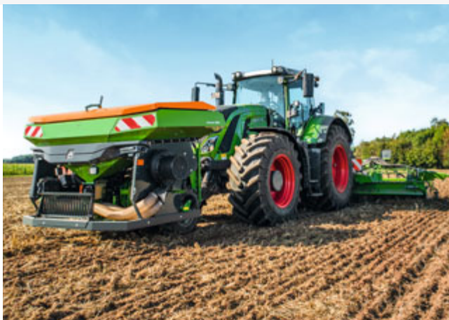
Trémie frontale FTender 1600 d'une capacité de 1 600 l
