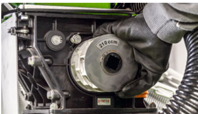
Changement facile de la bobine de dosage
