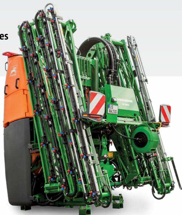
UF 2002 avec rampe Super-S2, largeur de travail 30 m
