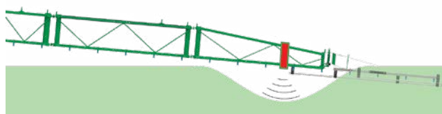
DistanceControl avec équipement deux capteurs : la rampe peut par exemple plonger dans la culture si les céréales sont versées
