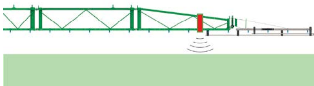
DistanceControl avec équipement deux capteurs : Mesure dans la culture
