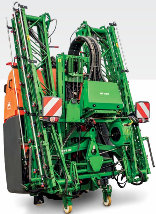
UF 1602 avec rampe Super-S1, largeur de travail 21 m
