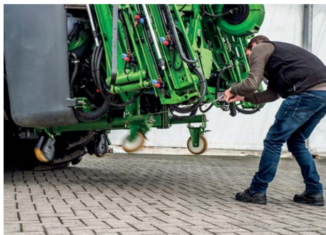
🔒 Pivotement facile des roulettes de manutention
